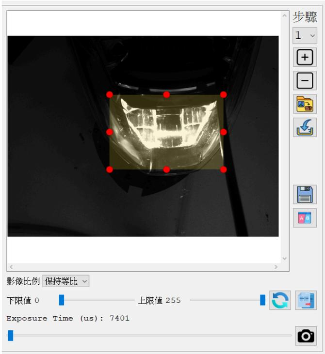
拖拉上方矩型檢測區域(ROI)，把車燈明亮處進行框選，再拖拉下方「下限值」拉把進行影像灰階值設定，圖示中會顯示車燈明亮處所佔影像的像素面積值。
